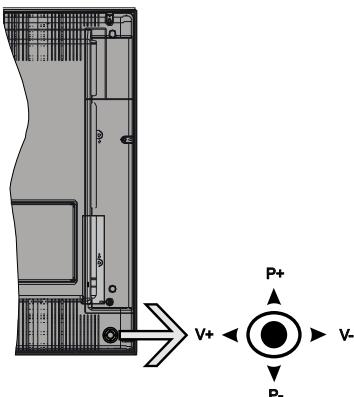
Maneta de control vă permite să controlați funcțiile Volum/ Program/ Sursă și Standby-On ale televizorului.
