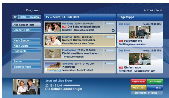
Фигура б: Приложение ARD EPG application, излъчваното видео се показва долу вляво и може да се прекъсне чрез натискане на бутона 0.
