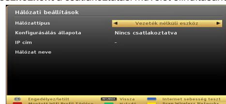
A Wi-Fi funkció engedélyezéséhez, a profilok megfelelő beállítása szükséges. Kérjük dugja be a Wi-Fi hardverkulcsot (*külön megvásárolható*) a TV egyik USB csatlakozójába.
