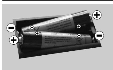
Először távolítsa el a hátrányító hátulján az elem tartó rekesz fedelét rögzítő csavart. Óvatosan emelje fel a felelet. Helyezze be a két **AAA** elemet.
