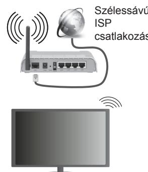
A vezeték nélküli-N router (IEEE 802.11a/b/g/n) szimultán 2.4 és 5 GHz sávval a sávszélesség növelését célozza meg. A gyorsabb és zökkenőmentesebb HD videó lejátszásra, fájltávitelre és vezeték nélküli játkéra optimalizálták.
